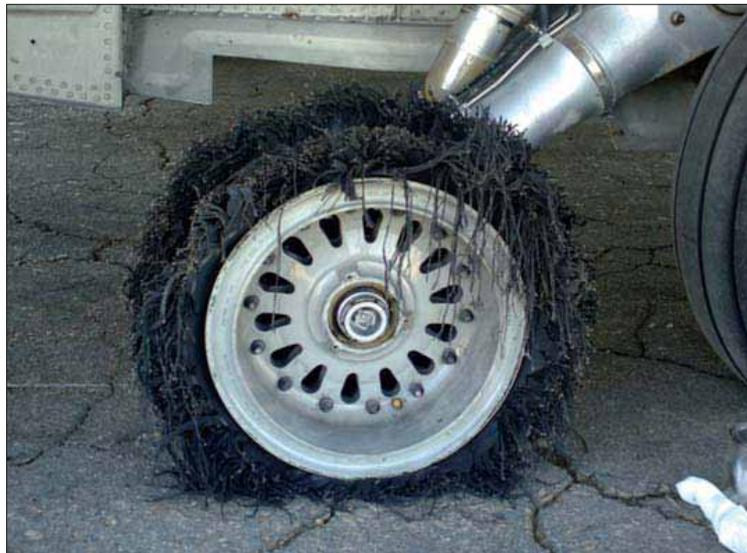
DETALLE DEL ESTADO DE LA RUEDA DEL TREN TRAS LA OPERACIÓN EN FARAH.
