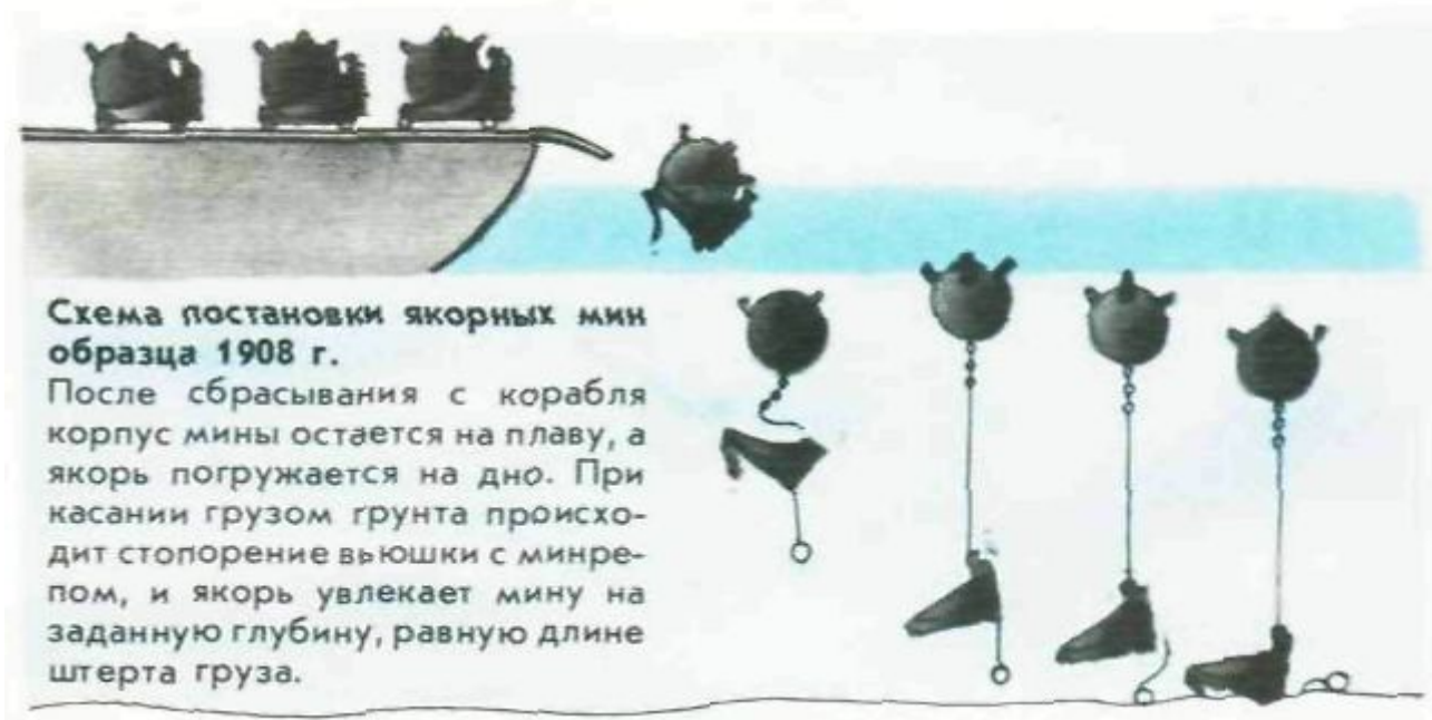
Рис. 4. Способ постановки мин Угрюмова.
