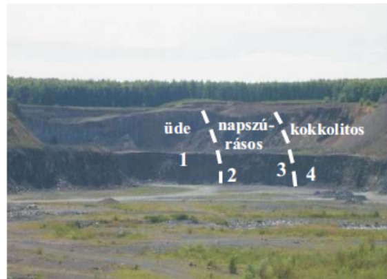
4. kép. Az uzsai bazaltbánya közettípusainak megjelenése a mintavételi pontok feltüntetésével (1: E 518060, N 173450 2: 518075, N 172700, 3: E 517985, N 172645, 4: E 517932, N 172679)
