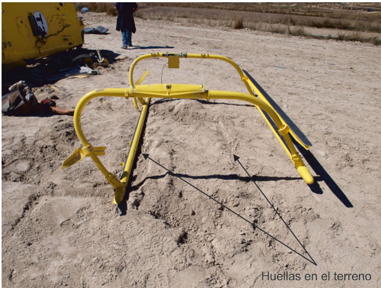
Figura 10. Deformación de tren de aterrizaje y huellas en el terreno
