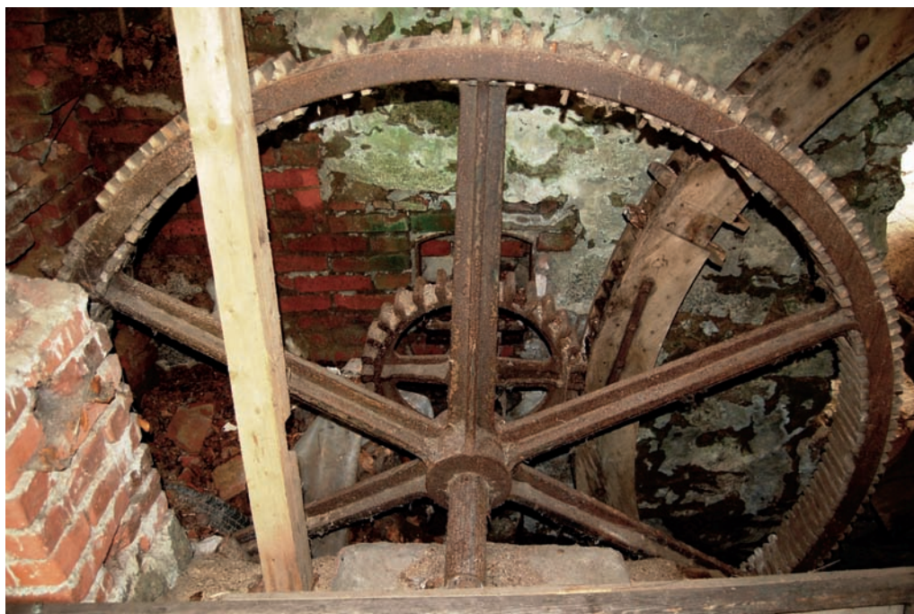
Obr. 9_ Hřídel s pastorkem a převodovým kolem, červenec 2012 Foto P. Freiwillich
