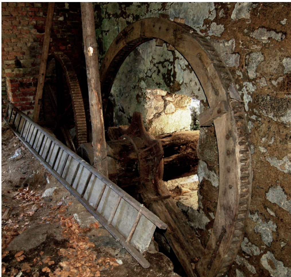
Obr. 7_Hlavní hřidel s palečným kolem, červenec 2012 Foto P. Freiwilling
