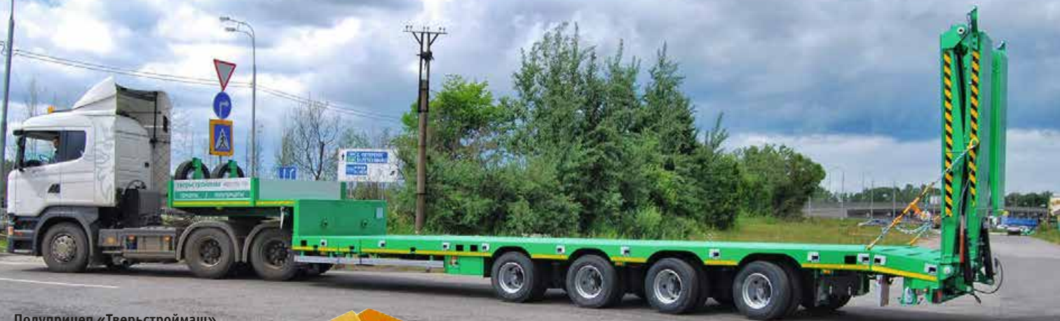
Полуприцеп «Тверьстроймаш» с раздвижной платформой и гидравлическими трапами
