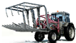
Fenix 800 Погрузчик фронтальный универсальный Грузоподъемность до 800 кг. Полный комплекс сменных адаптеров.
