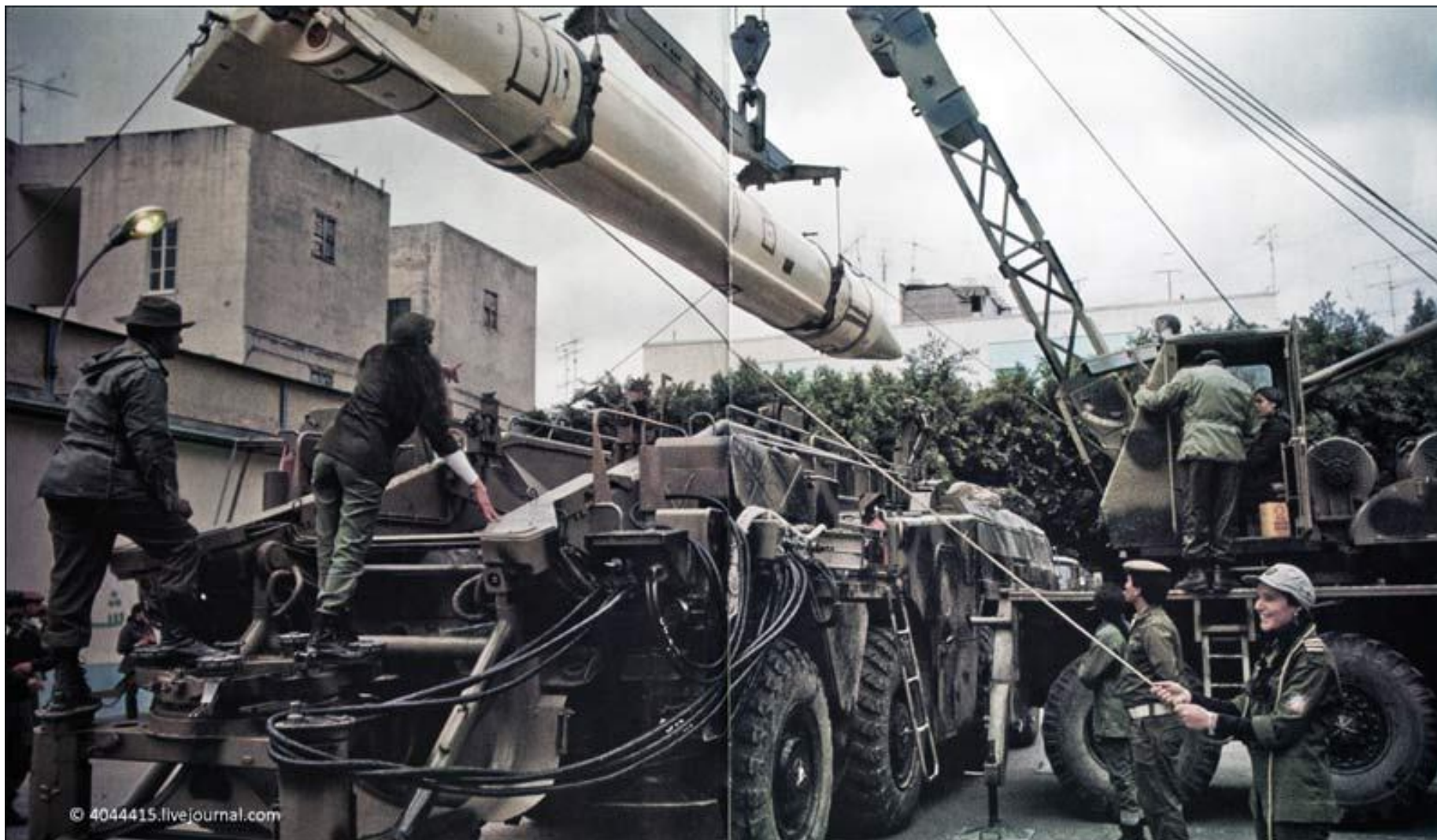
Тренировка по заряданию СПУ 9П117М комплекса 9К72 SCUD-B вооруженных сил Ливии, фото не позже 1981 г. (альбом Libya Jamahiriya. 1981 г., http://4044415.livejournal.com ).
