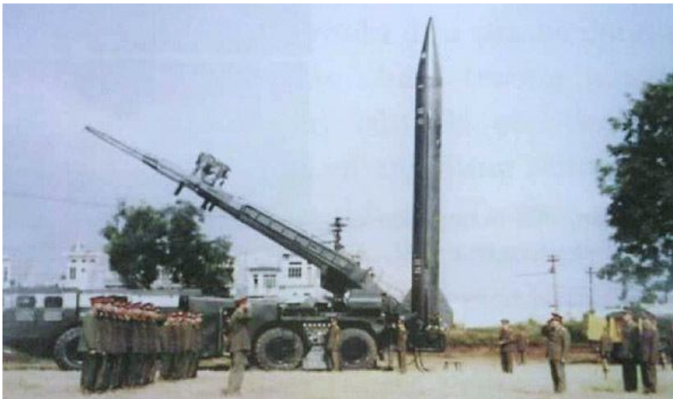
СПУ 9П117М комплекса 9К72Э SCUD-B вьетнамской армии, фото не позже 2008 г. ( http://www.b14643.de )
