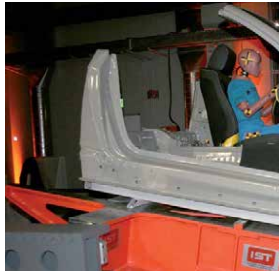
Erste servohydraulische Katapult-Schlittenanlage in Europa. Fotos: Frank Reichel
