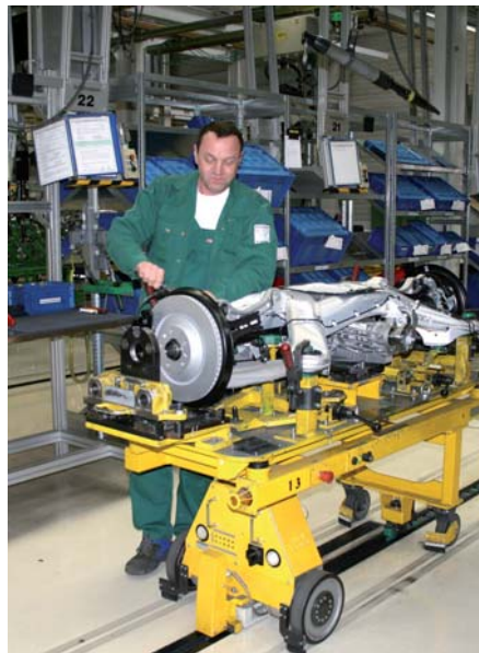
Achsmontage bei BMG Glauchau, ein ausgezeichnetes Beispiel für die Integration von Wertschöpfung in die Logistik.
