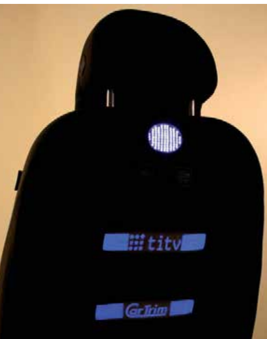
Textile Taster und Leuchtelemente am Sitz sind Innovationen, die Car Trim im Verbund mit Partnern entwickelt hat.
