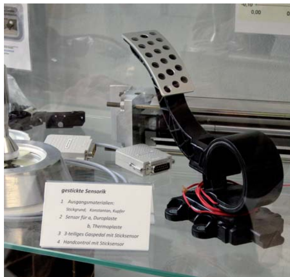
Gaspedal mit gesticktem Sensor von der TU Chemnitz.
