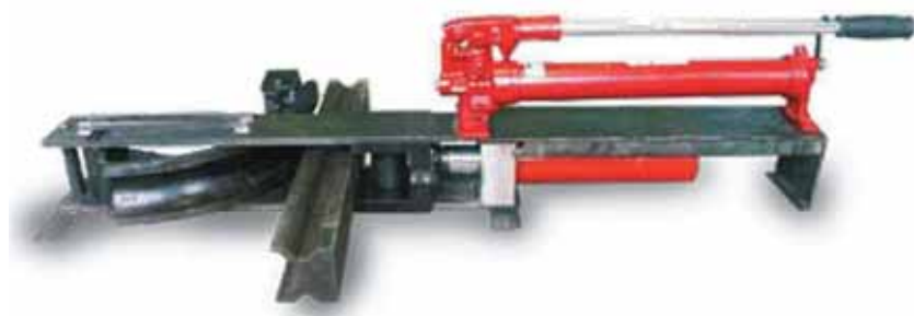
Рис. 21. Автономный трубогиб с открытой рамой
