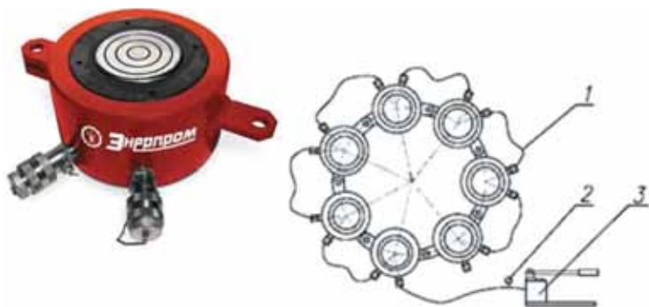
>>> Рис. 7. Толкающий домкрат-съемник и схема его соединения в цепочку: 1 – соединительные гибкие рукава сверхвысокого давления; 2 – манометр; 3 – ручной насос
