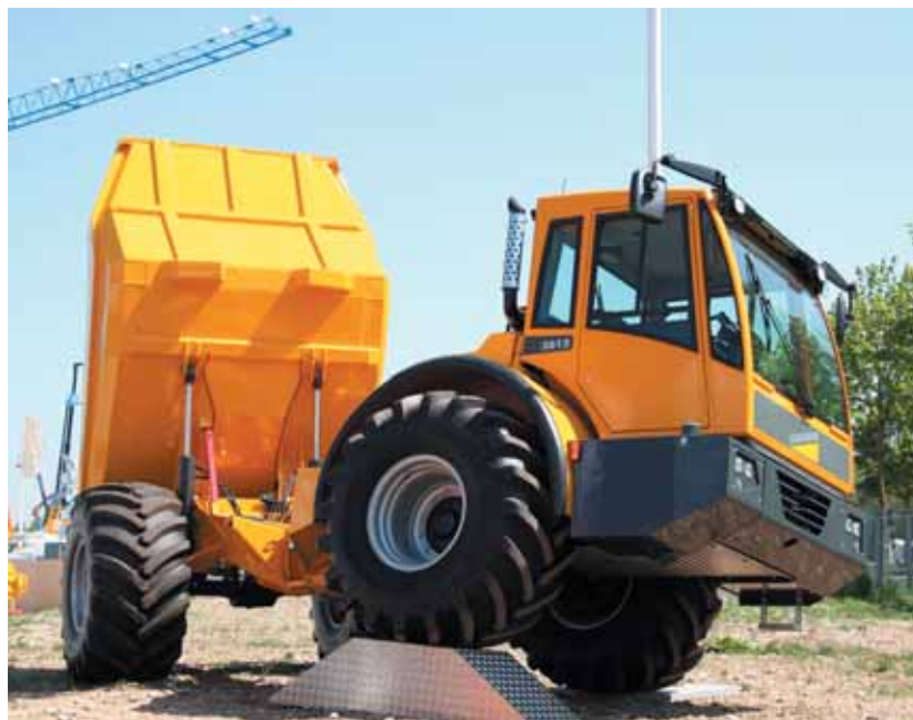
Думпер Bergmann 3012 грузоподъемностью 12 т с сочлененной рамой, кузовом задней разгрузки и поворотным местом водителя
