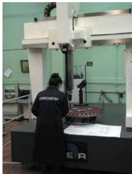
>>> В комнате точных обмеров (в которой поддерживается заданный микроклимат) на специальном оборудовании выполняются контрольные замеры деталей тракторных трансмиссий с точностью до микронов
