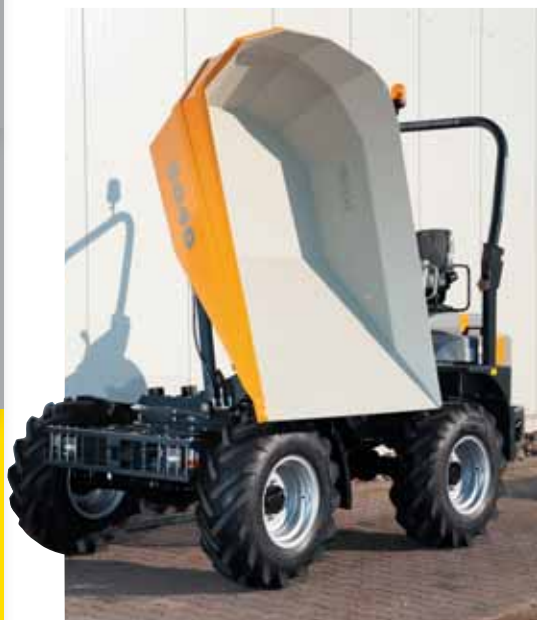
Думпер Bergmann 2040 грузоподъемностью 4 т с сочлененной рамой и поворотным на 180° кузовом
