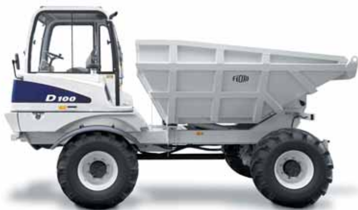
>>> Думпер Fiori D100 грузоподъемностью 10 т с жесткой рамой, управлением всеми колесами и поворотным местом водителя
