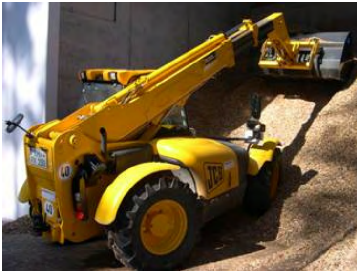
Befüllen des Hackschnitzelbunkers am Heizwerk „Am Weinberg“
