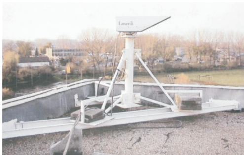
30. kép. Lézer adó-vevő a Rákóczi úti intézmény legmagasabb épületének tetején
