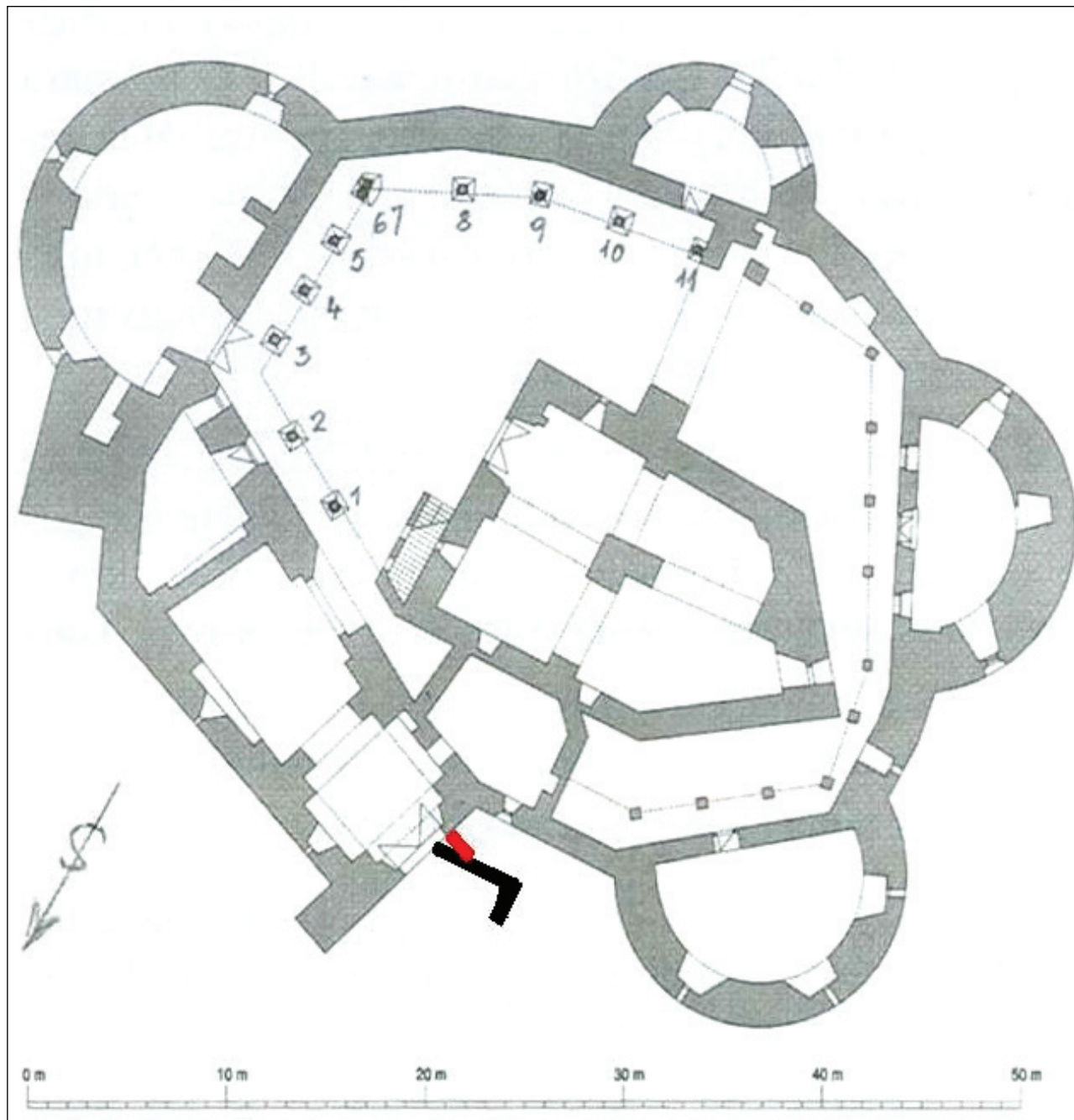
Tlocrtna situacija Velikog Tabora s novootkrivenim jugozapadnim uglom izvornoga ulaznog bastiona dvorca (crno) i mlađim popločenjem (crveno)
