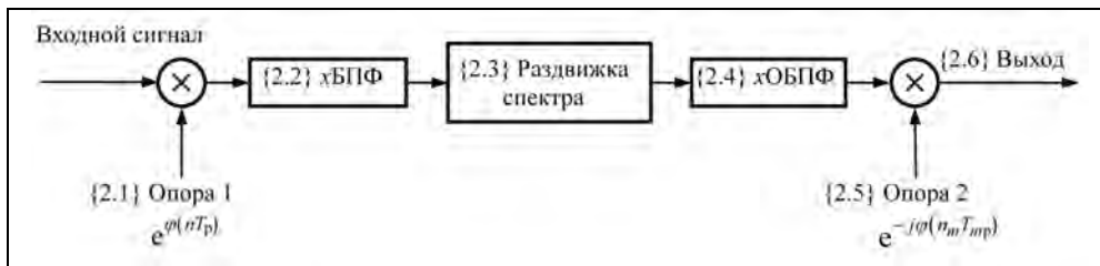
Рис. 6.21. Процесс интерполяции голограммы на повышенную частоту повторения
