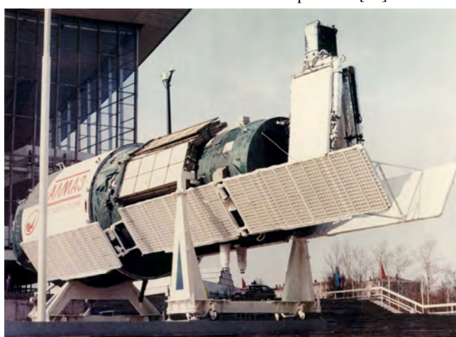
Рис. Ц.7. Общий вид космического аппарата «Алмаз-1» на ВДНХ с раскрытыми волноводно-щелевыми антеннами РСА «Меч-КУ» и подготовленной к раскрытию АФАР линии передачи данных. Солнечные батареи находятся в сложенном положении на корпусе КА
