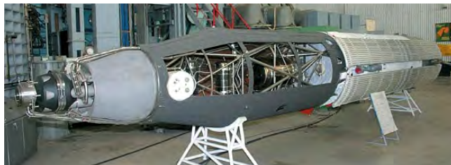
Рис. Ц.6. Демонстрационный комплект космического аппарата УС-АМ с раскрытыми антеннами РБО РИФ. ОКБ «Арсенал» [11]
