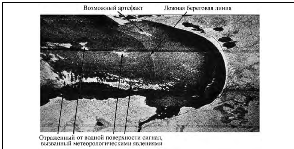
Рис. 3.24. Образование артефактов на РЛИ, вызванных неоднозначностью сигналов по азимуту
