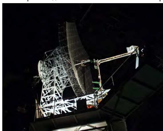
Рис. Ц. 8. Испытания в безэховой камере ОАО «ВПК «НПО машиностроения») гибридной зеркальной антенны РСА для космического аппарата «Кондор-Э»
