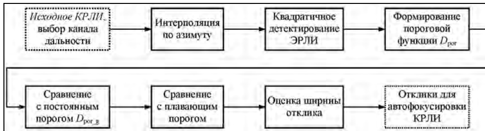
Рис. 6.52. Структурная схема выделения и анализа отметок от целей
