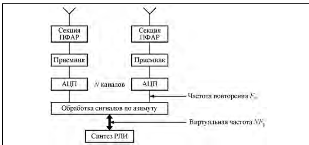
Рис. 4.12. Структурная схема обработки сигналов методом многоканального приема с секционированными приемными ФАР (ПФАР)
