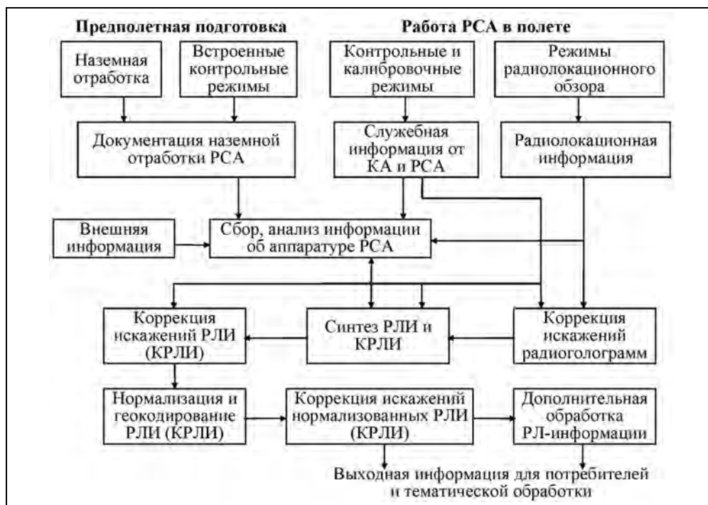
Рис. 11.7. Технологическая цепочка калибровки РСА
