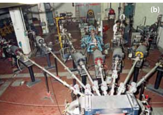
Fig. 9 (a) La colonna del CN potenziata a 7 MV di tensione. (b) Sala sperimentale del CN a 7 MV con le 7 linee di fascio e apparati di misura.
