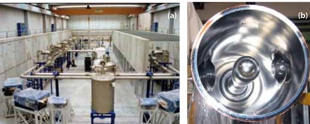
Fig. 23 (a) L'acceleratore ALPI a cavità superconduttrici. (b) Elemento QWR (risuonatore a \frac{1}{4} d'onda) di ALPI (v. testo).
