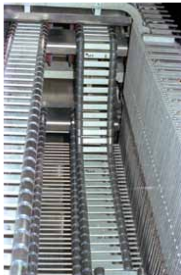
Fig. 20 Particolare del Laddertron (cinghia metallica di trasporto della carica).
