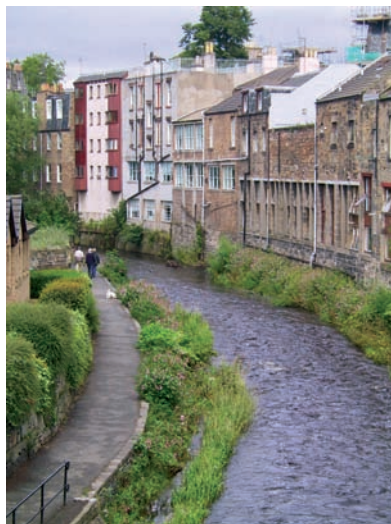
Fot. 7 i 8. Przykłady spoza Polski. Obniżenie ciągu pieszego biegnącego wzdłuż rzeki do poziomu średniej wody pozwoliło znacznie zwiększyć szerokość koryta, a przez to zmniejszyć prędkości wód wezbraniowych. Obecność roślinności strefy ziemno-wodnej (prawe zdjęcie) dowodzi, że prędkości przepływu umożliwiają ich egzystencję (©Arup)
