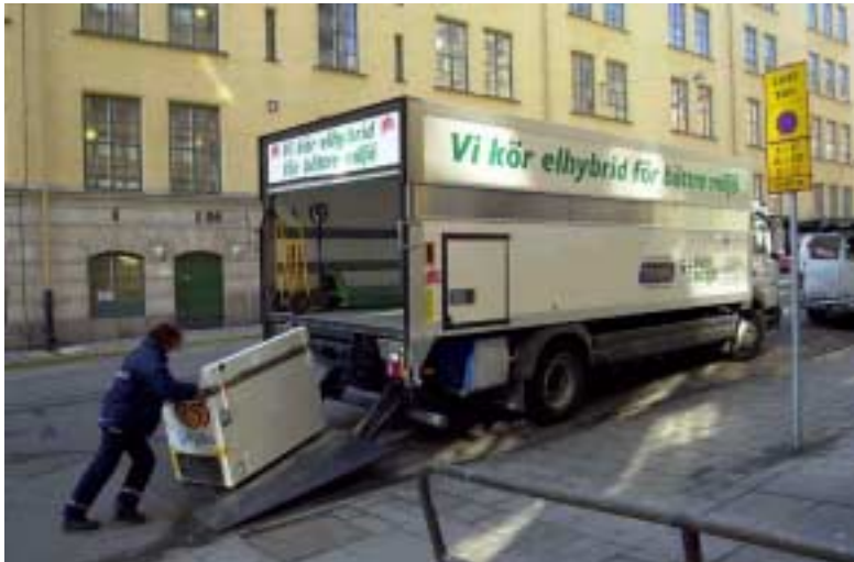
Figur 9: Hybridlastbilen Atego från DaimlerChrysler (Foto Mikael Röhr)
