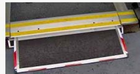
Rampe courte portes 2 et 3
