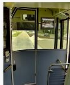
Loge conducteur intégrale fermée
