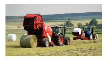
Am Beispiel der Ballenpressen lässt sich die Umsetzung des oben beschriebenen Projektes TIM (Tractor-Implement-Management) gut illustrieren. Die Maschine regelt dabei die Fahrgeschwindigkeit des Traktors über die Auslastung der Maschine mit der Zielsetzung, einen störungsfreien und kontinuierlichen Ablauf des Pressvorgangs bei höchster Pressdichte und Flächenleistung zu erreichen.
