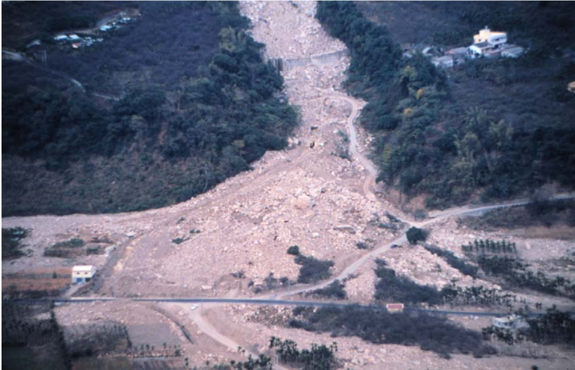
豐丘土石流經上方狹窄流動區而下，於小溪溝溝口形成一規模相當大的沖積扇。
