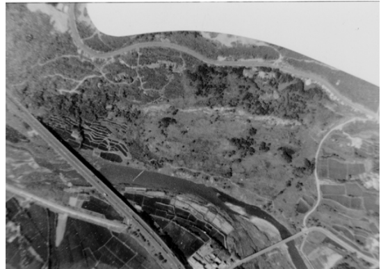
民國七十七年拍攝。堵塞鳳山溪的崩塌物質已被完全侵蝕，東西向的崖現已延伸至崩塌區東緣。
