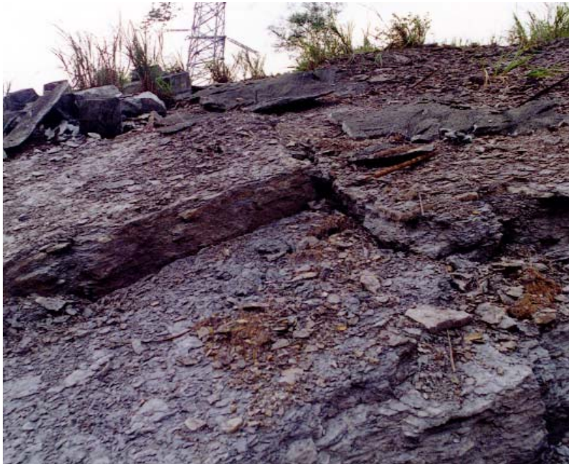
滑動區的地質材料主要是薄頁互層夾薄層砂岩，風化後即呈鬆散軟弱。
