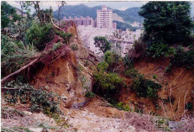
分隔A、B滑動體之縱向張力裂隙，照片右側為A滑動體，左側為B滑動體。
