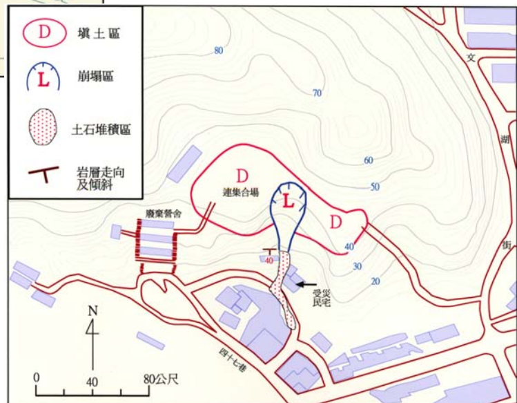
崩塌區及土石流位置圖。
