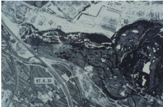
民國六十七年拍攝。崩塌區內有疑似小崩崖的明顯線形，東西二側坡面並無異狀。
