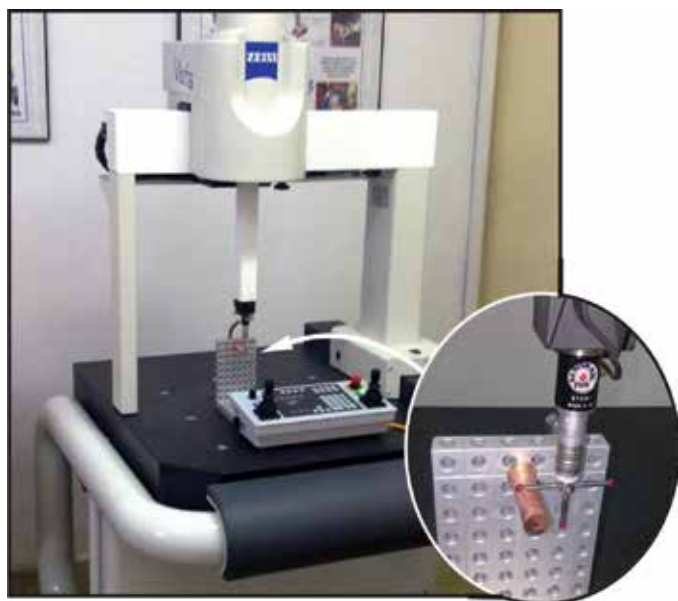
Maszyna współrzędnościowa Vista podczas pomiarów w Zakładzie Wspomagania Projektowania, Wytwarzania i Eksploatacji Instytutu Techniki Uzbrojenia WML
