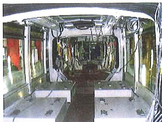
Conexão de toda a fiação interna a uma bancada de teste.
