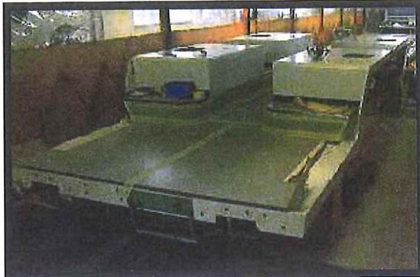
Chassi de aço montado e pronto para ser despachado
