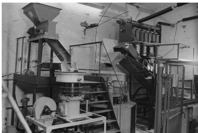
Рис. 18. Установка для раскрытия камнесамоцветного сырья (на стенде КНЦ РАН)
