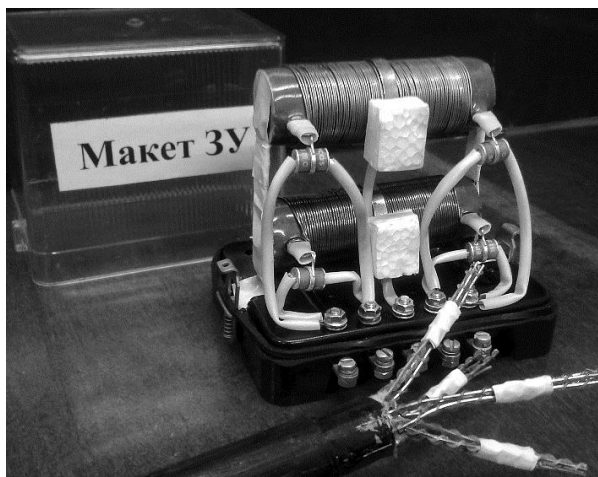
Рис. 5. Устройство, одновременно ограничивающее опасные напряжения и токи в системах телеуправления при коротких замыканиях во влияющих высоковольтных сетях
