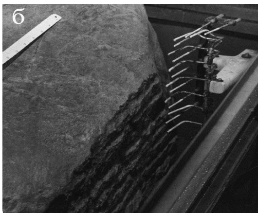
Рис. 17. Схема пассивки блоков природного камня. Рисунок установки (а), инструмент и блок нестандартного валуна в процессе пассивки (б) и после пассивки в распиловочном станке (в)
