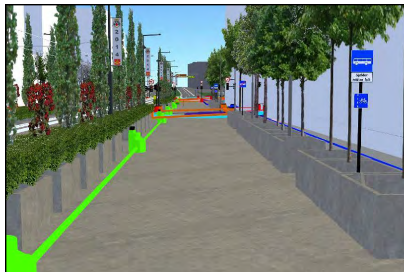
Plantekasser i fortau og midtrabatt over betongplaten
