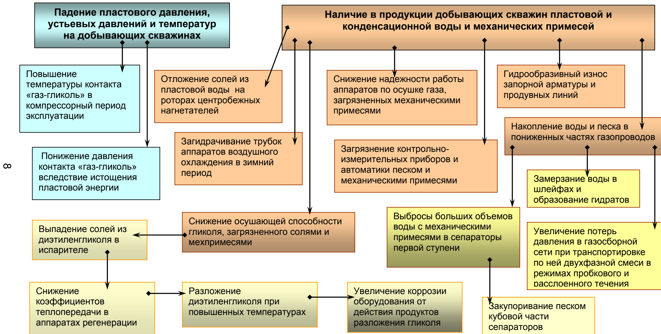
Рисунок 2 - Негативные факторы в завершающий период разработки сеноманских залежей в подсистемах промышленного транспорта, компримирования и подготовки газа как следствия падения пластового давления, обводнения добывающих скважин и разрушения их призабойных зон
