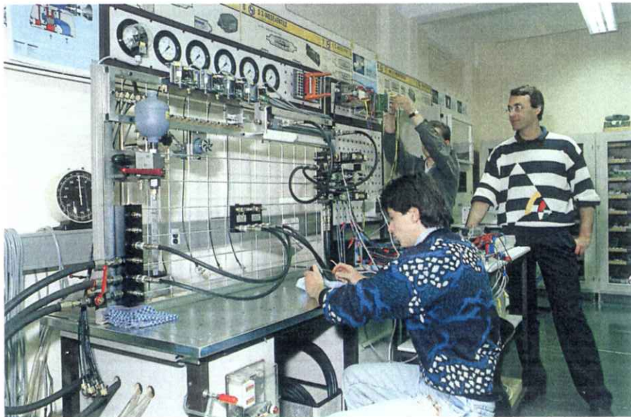
Übungen am Hydraulikprüfstand in Verbindung mit einer SPS-Steuerung
