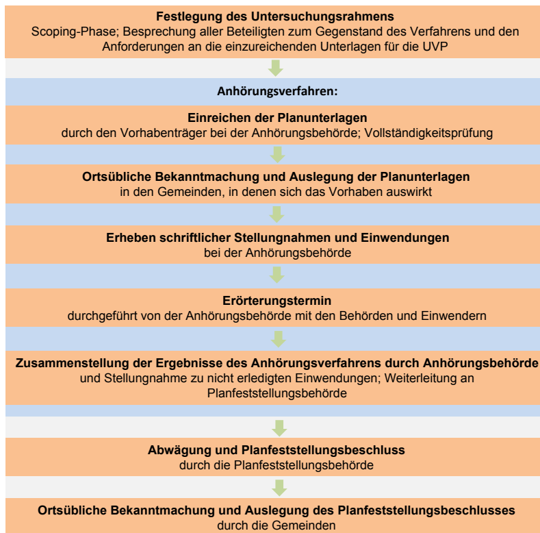
Abb. 8: Ablauf Planfeststellungsverfahren mit UVP
