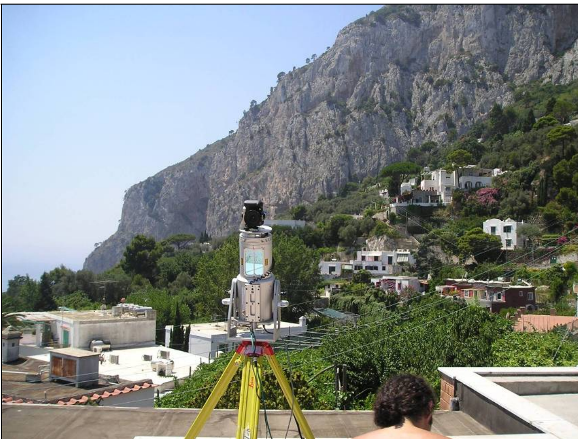
Fig.5 – Laser Scanner RIEGL® Z420I posizionato sulla II stazione di misura posta sul tetto dell'ospedale di Capri
