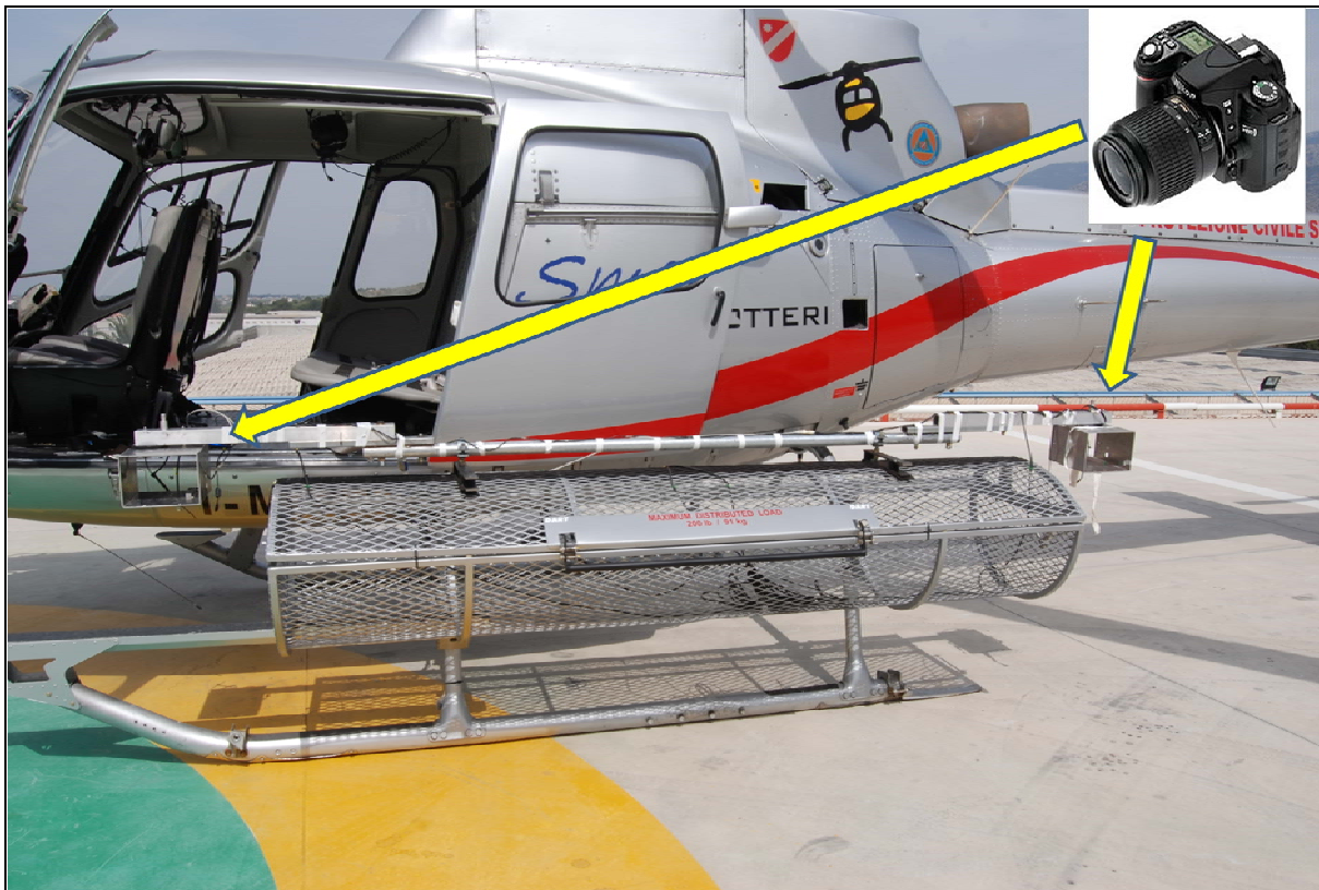
Fig.7 – Strumentazione di rilevamento fotogrammetrico della falesia, montata su elicottero
