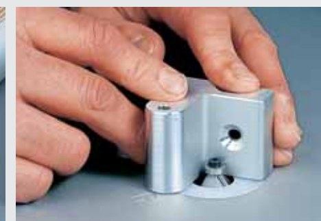
Entgraten mit Kunststoffeinlage
