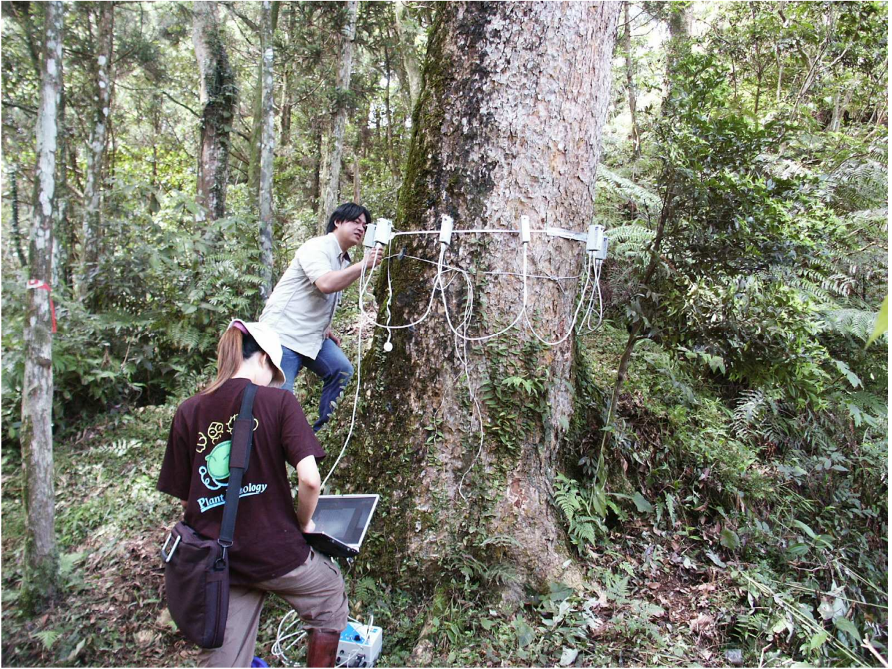
圖四、利用應力波測量儀測定台灣油杉木材腐朽情形
