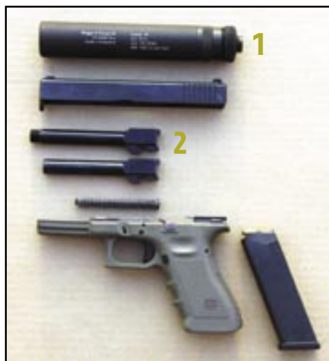
9mm pistole Glock 17 rozebraná k čištění – verze s tlumičem hluku výstřelu
