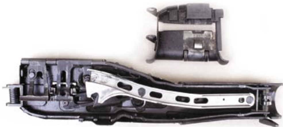
Detail víka pouzdra závěru s mechanismem posouvání nábojového pásu a skluzavkou
