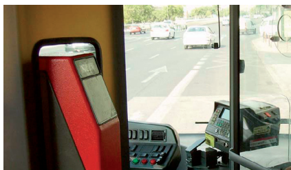
Ilustración 7: Dispositivo RFID en transporte público
