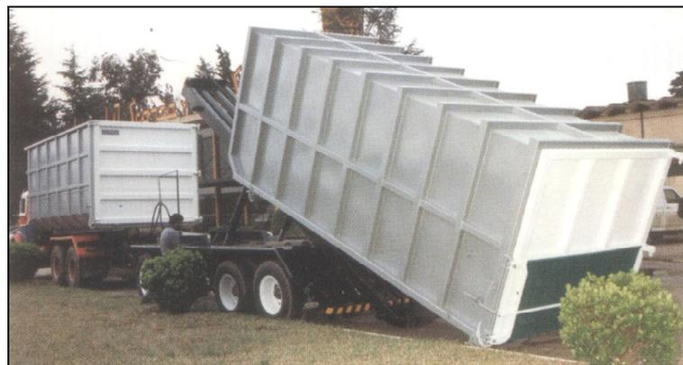
Figura: Sistema roll-off (camión y acoplado)
