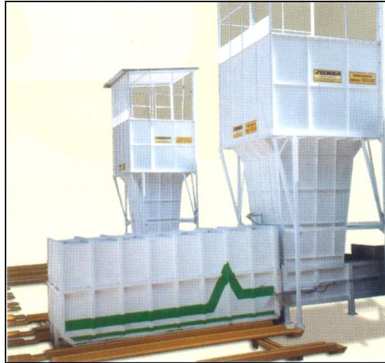
Figura: esquema de carga de contenedor desde tolva en PT.
