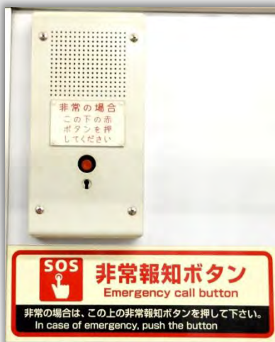
非常報知ボタン (東豊線車両)
