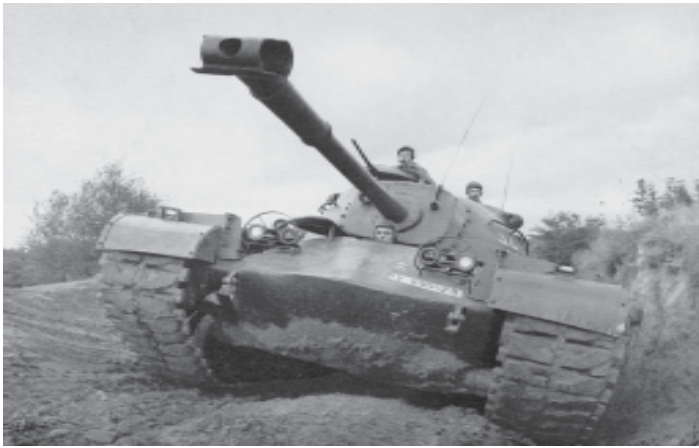
Bild 2: KPz M 48 A1 im Gelände; Turm- und Wannengehäuse bestanden aus Panzerstahlguss.
