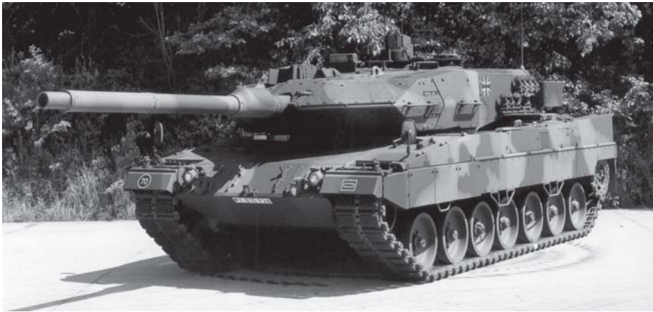
Bild 9: KPz Leopard 2 A6 mit der langen 120 mm Glattrohr-Kanone.
