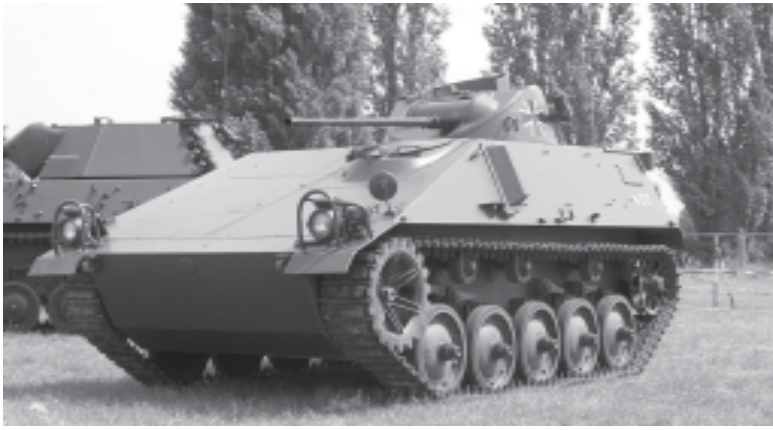
Bild 12: SPz-kurz (Hotchkiss) mit 20 mm MK – hier bei der Ausstellung „50 Jahre Bundeswehr“ auf der WTD 51 in Koblenz.
