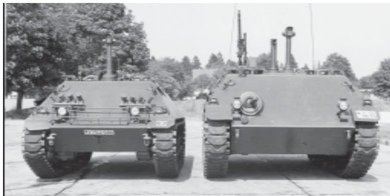
Bild 25: RakJPz 1 auf Basis HS 30 (links) im Vergleich mit RakJPz 2 (rechts) aus der SPz-neu – Familie; beide Fahrzeuge waren mit dem frz. LFK SS 11 ausgestattet.
