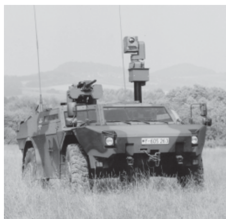
Bild 24: Spähpanzer Fennek mit ausgefahrter Beobachtungsplattform und 40 mm GMW zur Eigenverteidigung.
