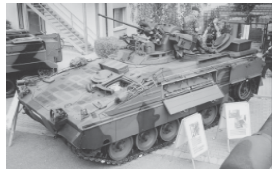
Bild 15: SPz Marder 1A5 – die derzeit modernste Version mit Zusatzpanzerung und Minenschutz (Gewicht: 37,5 to).
