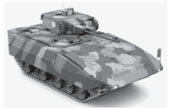
Bild 17: Konzeptentwurf für den zukünftigen SPz Puma; im Turm befindet sich keine Besatzung; Gewicht: 31,45 – 41 to (geplant).
