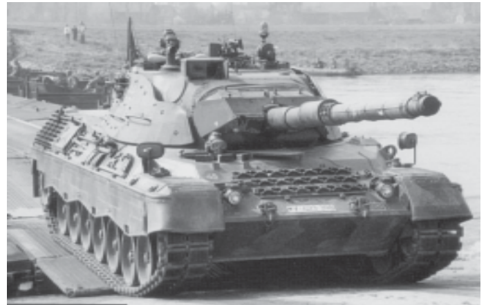
Bild 4: KPz Leopard 1 A5; mit der modernen Feuerleitanlage (EMES 18) in Verbindung mit der Pfeilmunition DM 43 konnte ein beträchtliche Steigerung der Feuerkraft erzielt werden!
