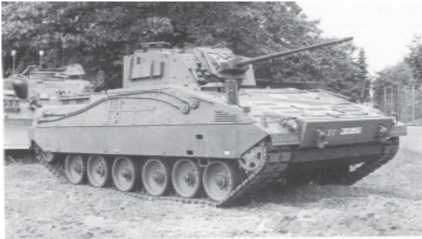
Bild 16: Versuchsträger Marder 2 aus dem Jahr 1991 mit Zweimann-Turm und 35/50 mm MK; Gewicht: 40,6 to.
