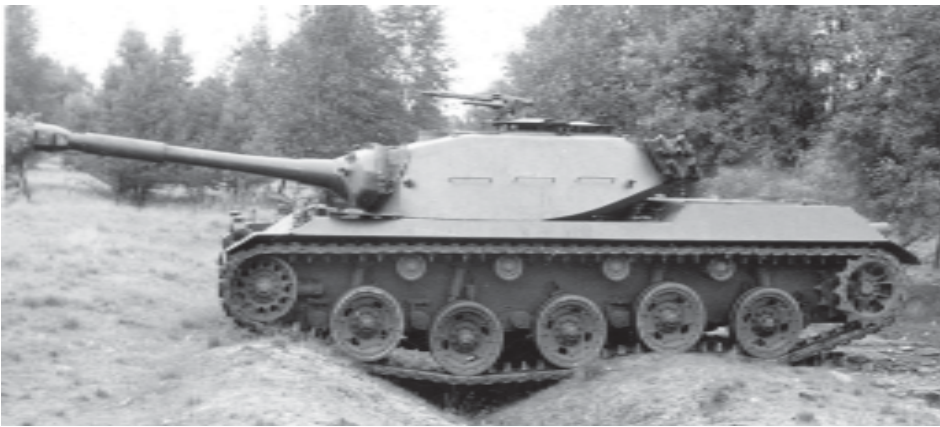
Bild 20: Prototyp des Spähpanzers RU 251 von Hanomag aus dem Jahr 1963 mit 90 mm PzK; das Konzept wurde aufgegeben.
