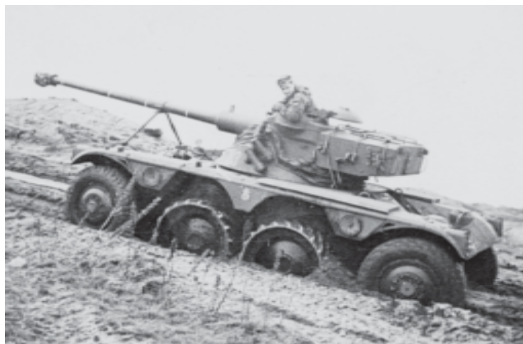
Bild 18: Erprobung des frz. Spähpanzers EBR 75 in Munster; das Fahrzeug wurde nicht in die BW eingeführt.
