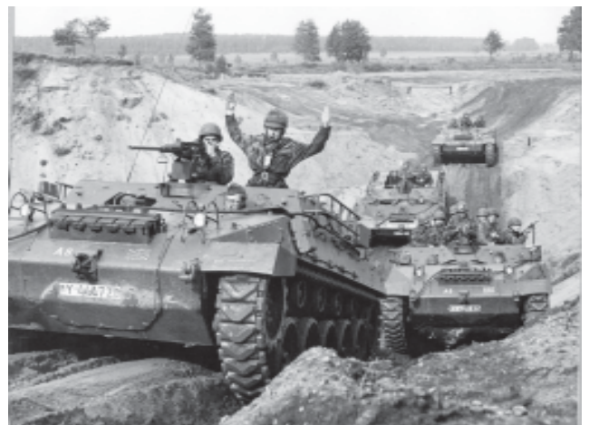
Bild 11: US-Transportpanzer M 39, in den Anfangsjahren im Pz-GrenLehrBtl in Munster ebenfalls als Schützenpanzer eingesetzt.
