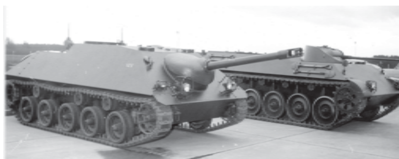
Bild 26: Prototyp eines Kanonenjagdpanzers mit der französischen 90 mm DEFA-Kanone auf Fahrgestell HS 30 neben dem SPz-Prototyp RU 121.
