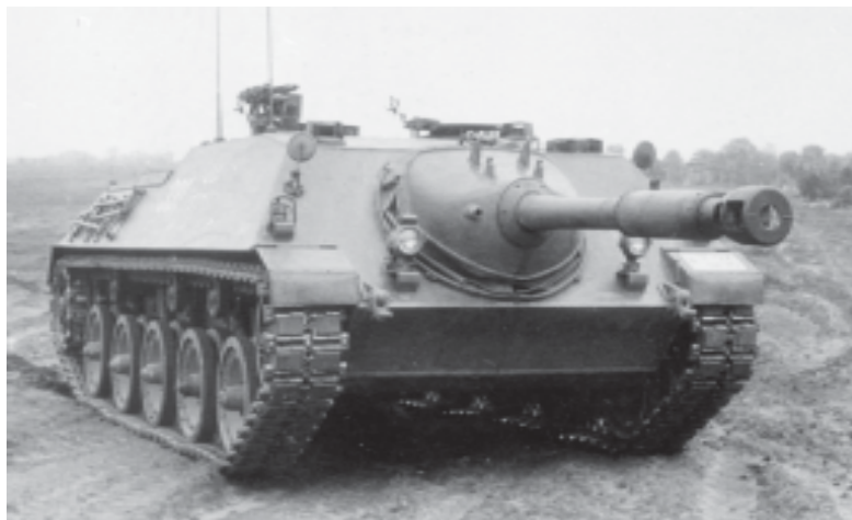
Bild 27: JPz Kanone mit verkürzter 90 mm PzK; das Konzept knüpft an die Jagdpanzer-Entwicklungen des 2. Weltkrieges an.
