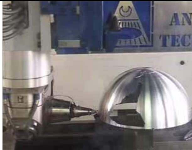
10. ábra Vékonyfalú alumíniumgömb vágása
