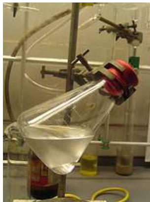
Slika 1.7: Razdvojeni metanol i heksan na sobnoj temperaturi
