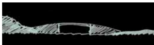
Typ »Djurgårdsbrunn« – markerade utbyggda landfästen.
