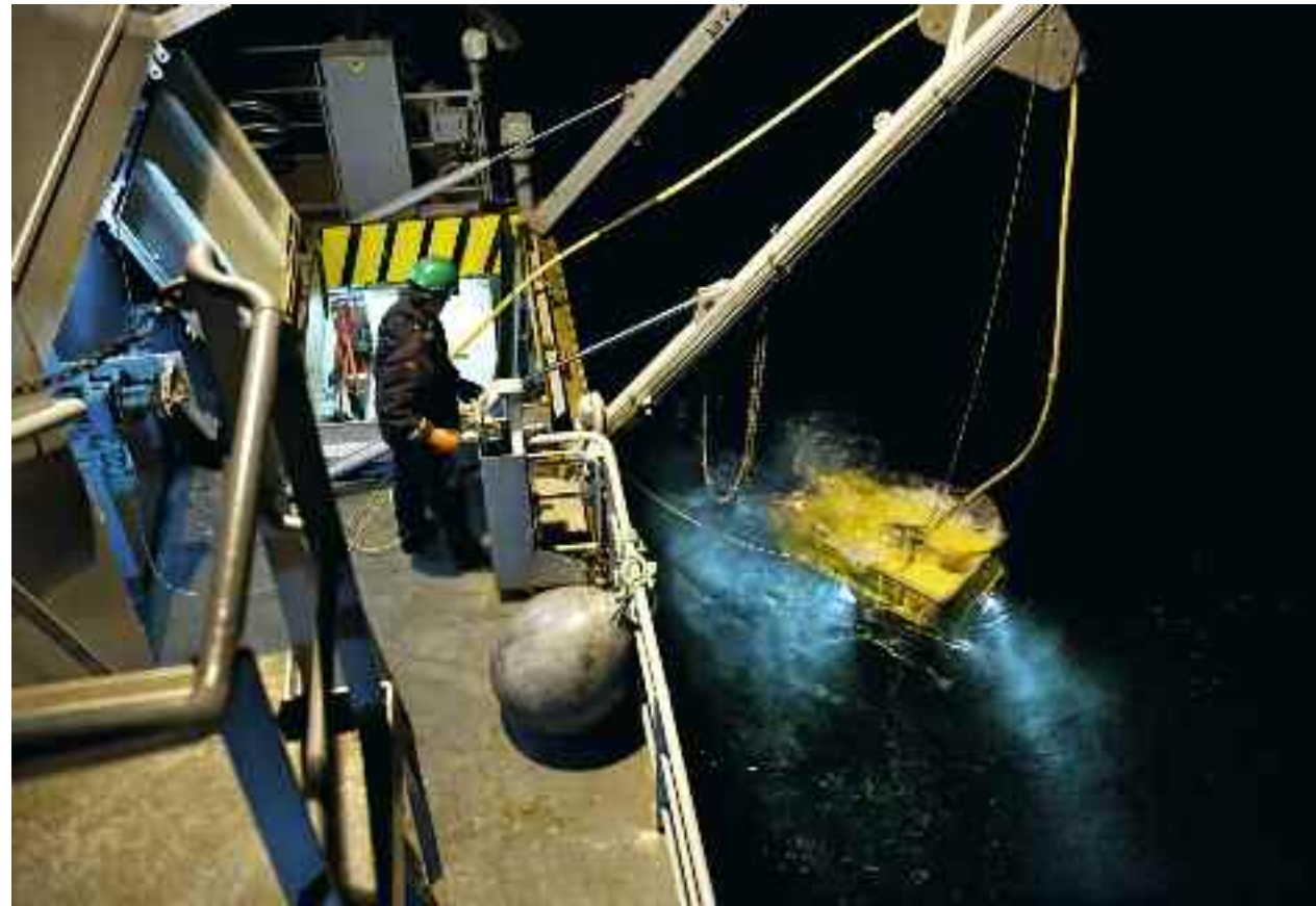
SKORPIONEN: ROV-en er gul og lysende i det svarte havet, med seks hurtiggående propeller (trustere) og to fangarmer. FOTO: TORBJØRN LØVLAND
