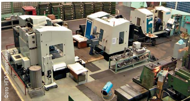
▲ Фрезерно-обрабатывающие станки HURCO в сборочно-сварочном цехе
