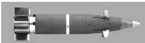
5. kép: Amerikai fejlesztésű M982 Excalibur lövedék
