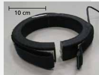
Kuva 3. Avattava Rogowskin kela käyttöpaikalla tehtäviä virtakalibrointeja varten.
