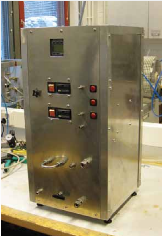
Kuva 1. Hiukkasten lukumäärätiheyden mittanormaali perustuen hiukkasten varaamiseen ja sähköiseen havaitsemiseen.
