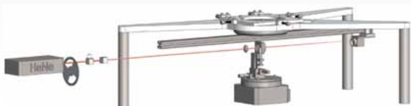
Kuva 3. MIKESin skatterometrin hahmotelma.
