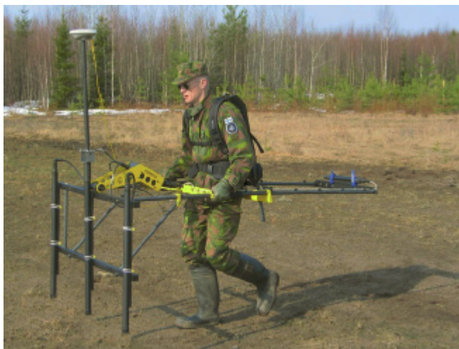
Kuva 12. GPS-paikantimella, dataloggerilla ja kolmella magnetometrianturilla varustettu syväetsin Joroisten EOC-työmaalla (Explosive Ordnance Clearance). (SA-kuva)
