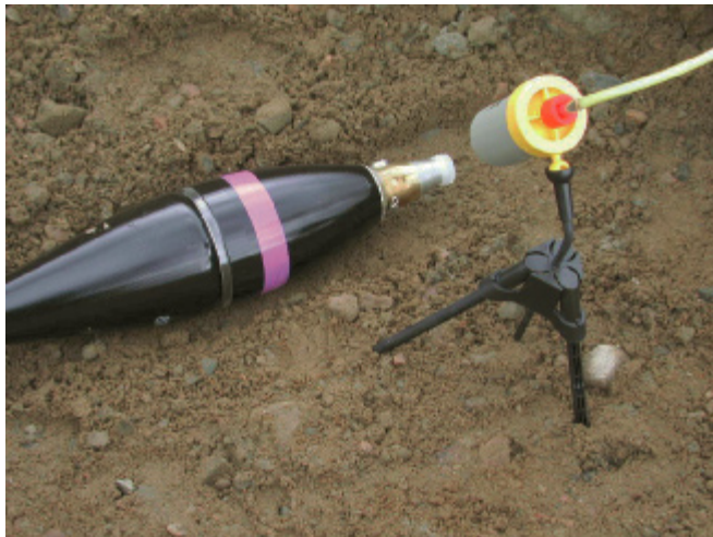
Kuva 11. Sytyttimen rikkominen rikkomispanoksella (SA-kuva)
