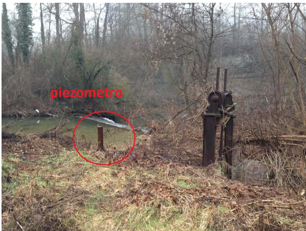
Figura 6: piezometro utilizzato per monitorare il regime idrologico del Torrente Mondalavia.
