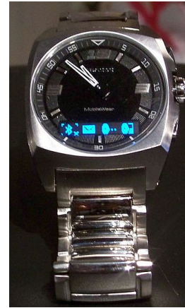
Telefoniga ühenduses olev kell, mis näitab kes helistab ja võimaldab telefoni juhtida
