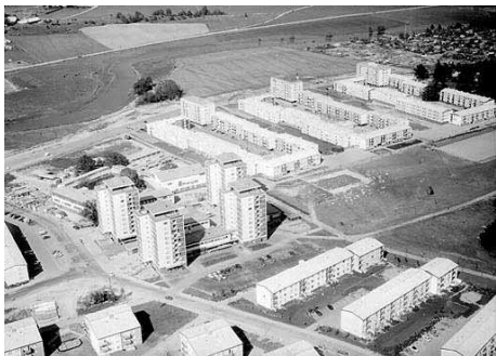
Johannelund, Linköping: hypermodernt ABC-område med trafikseparering och zonindelning: centrumanläggning med punkthus och omgivande lägre lamellhuskvarter. Foto AB Flygfrakt 1961
