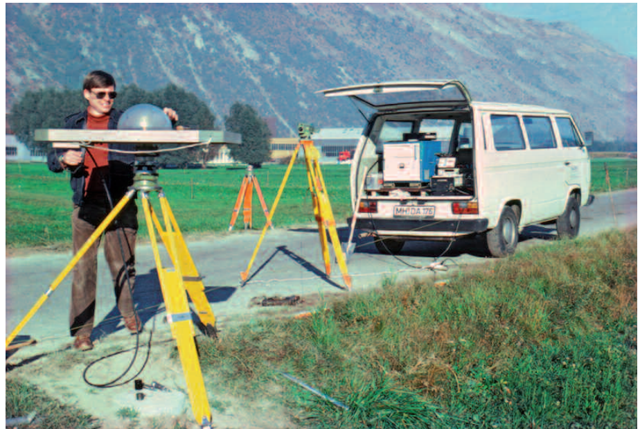
Abb. 8: Die ersten GPS-Messungen mit dem Macrometer V-1000 im Jahre 1985, SGK Band 51, S. 10.
