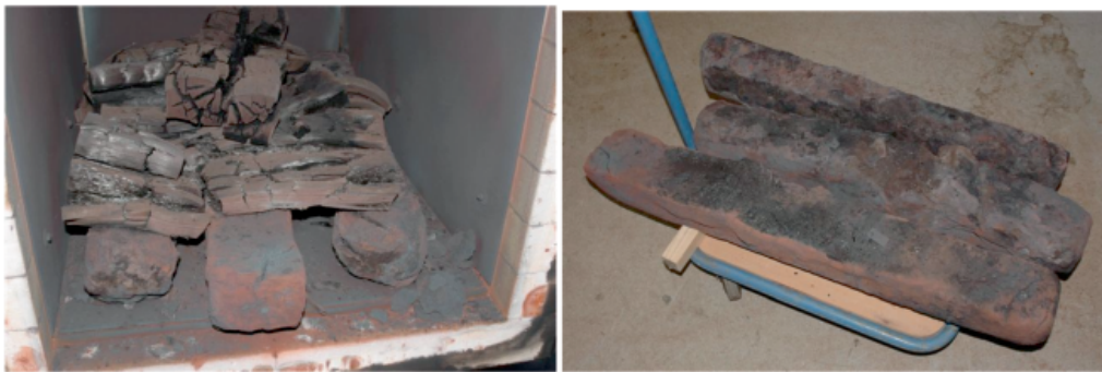
Foto 2, (links) Het ijzer en hout direct na opening van de oven. Het hout is verkoold, maar niet verast.
