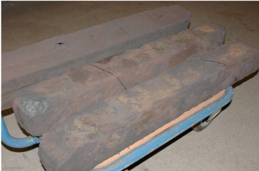
Foto 6) De baren na het stralen. Het ijzer is donkergrijs met nog slechts een dun laagje, dat iets rood tekent.
