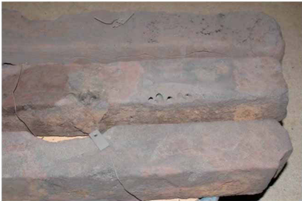
Foto 7) Detailopname van het schoongemaakte en (licht) gestraalde ijzer. De vorm is vrij strak, maar met hier en daar gietblazen, uitgebrande holtes van waarschijnlijk voormalige insluitingen en uitstulpingen van het gieten. Let op de aan de onderkant aangebrachte uitsparingen als handvatten. Deze zijn op alle baren aanwezig.
