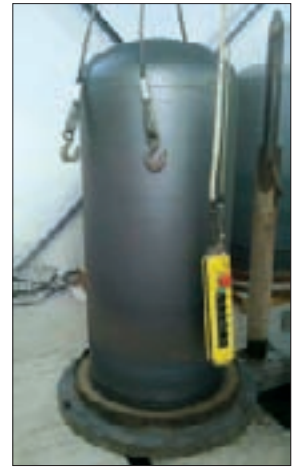
18. ábra: Retortás kemence Ni-bázisú ötvözetből
