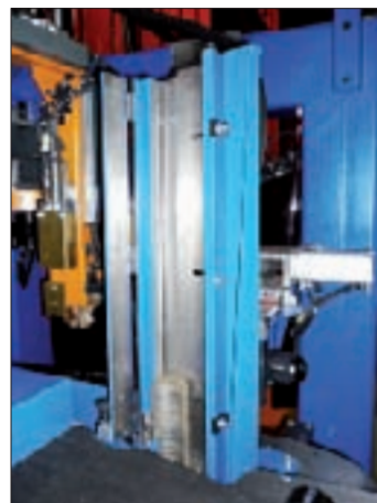
4. kép: Az adagoló különböző típusú uszonybordát képes befogadni, így nagyfokú rugalmasságot biztosít
