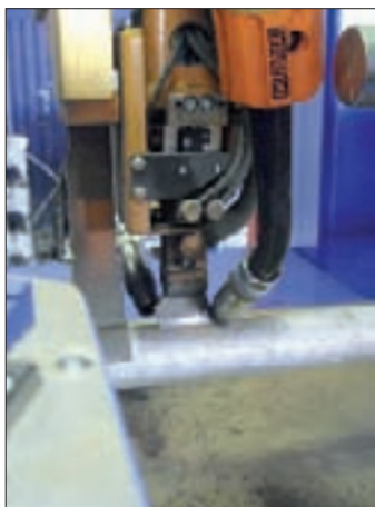
2. kép: Az ésszerűen kialakított, szemben elhelyezett, ellentétes irányban mozgó két hegesztőpisztoly
