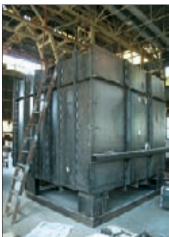
19. ábra: Kamrás kemence – szakaszosan ráhegesztett merevítőbordákkal
