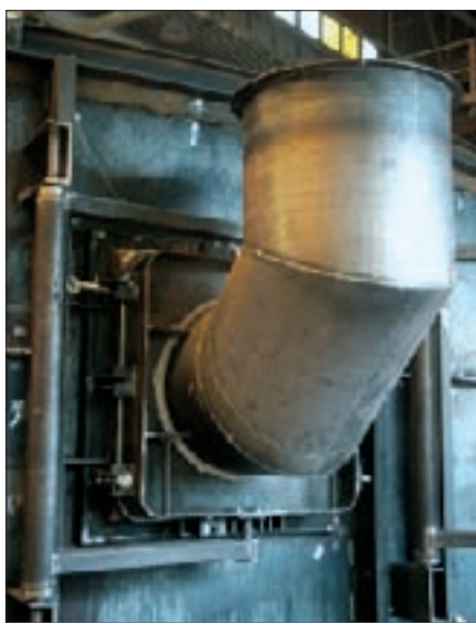
26. ábra: Kemenceajtóba épített hűtőcsonk
