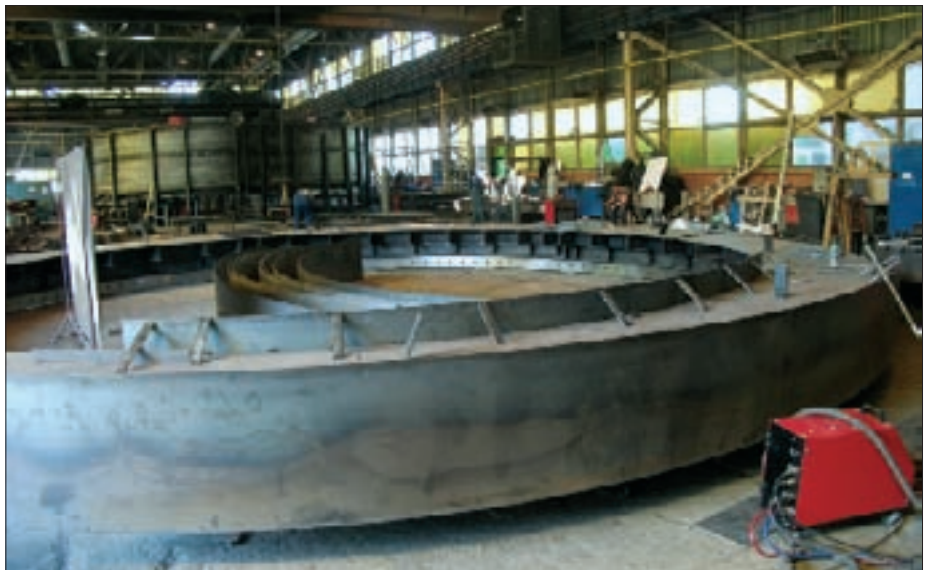
25. ábra: Gyűrűs kemence asztalának összeállítása
