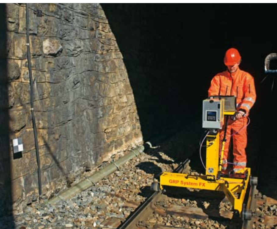
Aufgebauter Laserscanner auf Trolley mit Vermessungsfixpunkt an Tunnelwand
