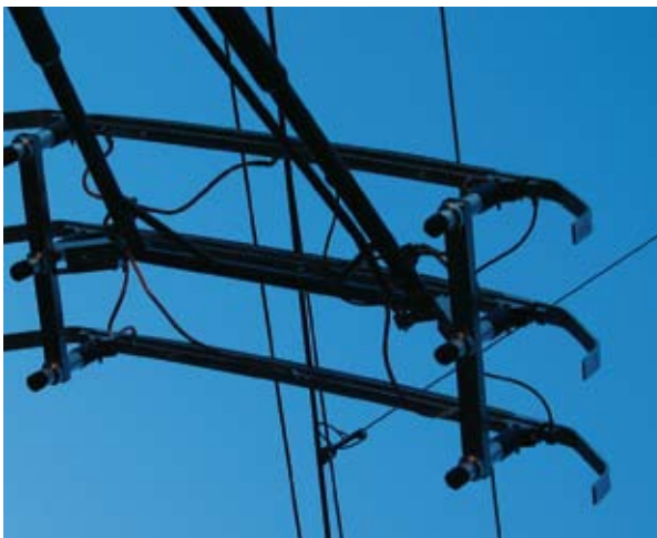
Neuer Stromabnehmer mit drei Schleifleisten.
