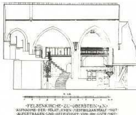
Bild 15: Aufriss des nördlichen Seitenschiffes 1927; hier sind deutlich die unterschiedlichen Größen der Gurtbögen erkennbar
